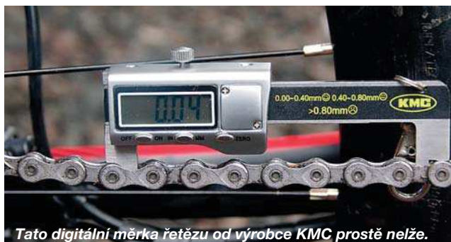
Tato digitální měrka řetězu od výrobce KMC prostě nelže.
