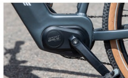
Motor čínsko-japonské produkce s vlastním softwarem značky Rock Machine je v rámu úhledně zabalen.
