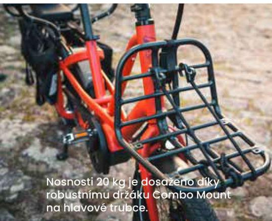
Nosnosti 20 kg je dosaženo díky robustnímu držáku Combo Mount na hlavové trubce.
